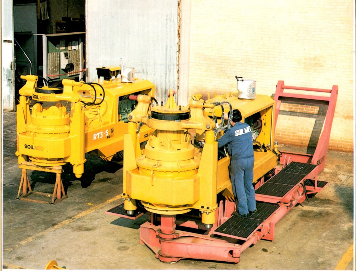
RT3-S su banco di collaudo durante la misurazione della coppia massima di stallo. / RT3-S rig on test stand during measurement of max. stall torque.
