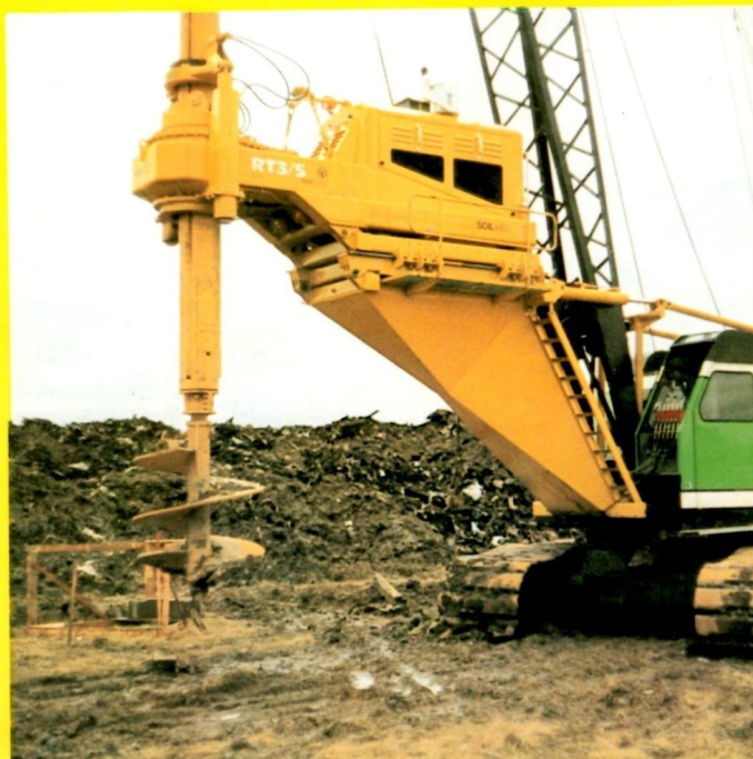
RT3-S con slitta di posizionamento fino a 60 cm del telaio superiore (BIRMINGHAMMER - CANADA). RT3-S with positioning skid allowing 60 cm stroke of the upper chassis. (BIRMINGHAMMER - CANADA).
